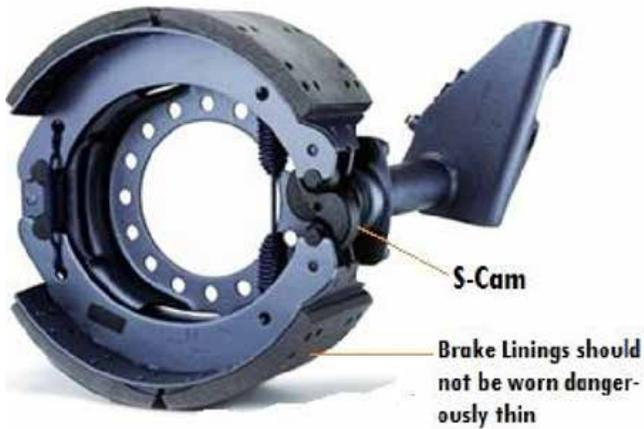
**Figure 11.25 Brake Linings**
